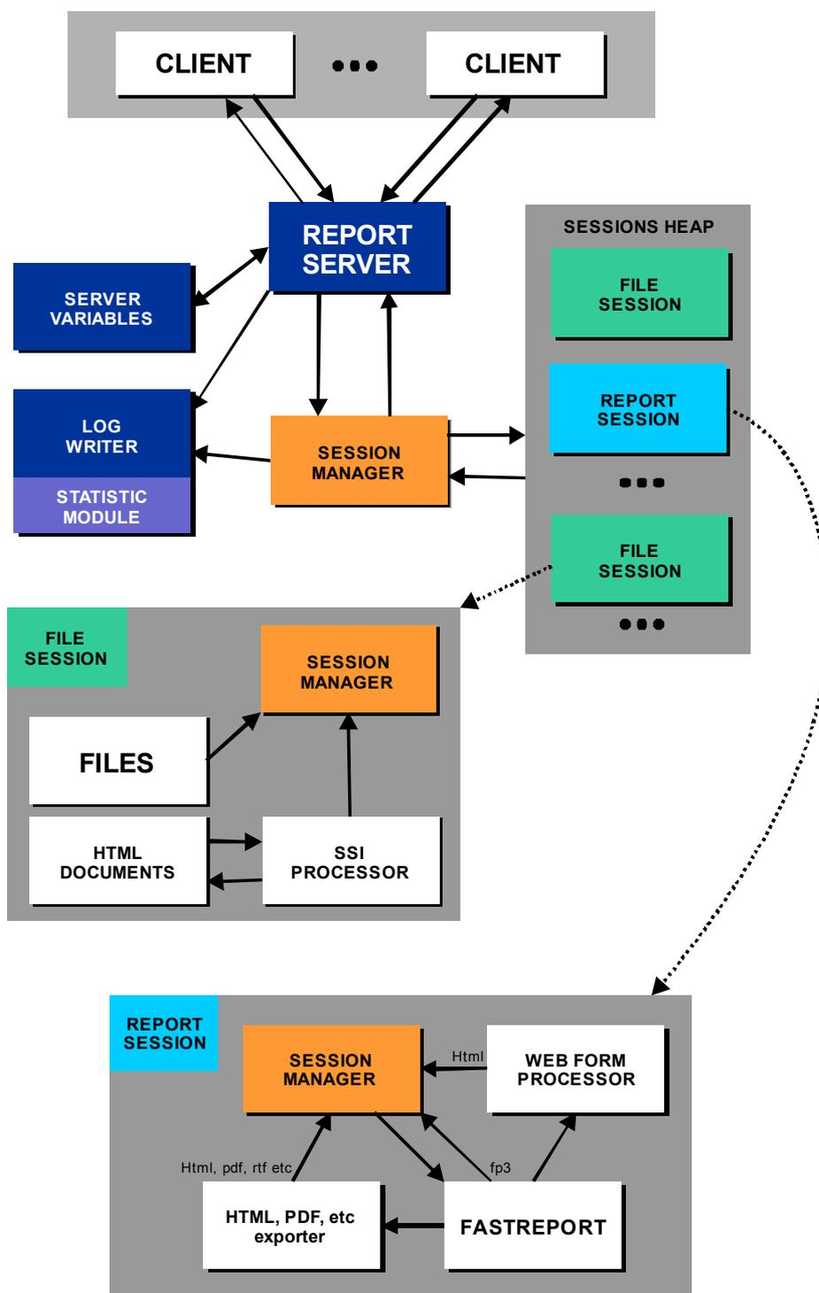
Принцип работы сервера наглядно показан на следующей схем
